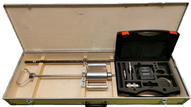
Utrustning för porgasprovtagning med porgasspjut och luftpump.
