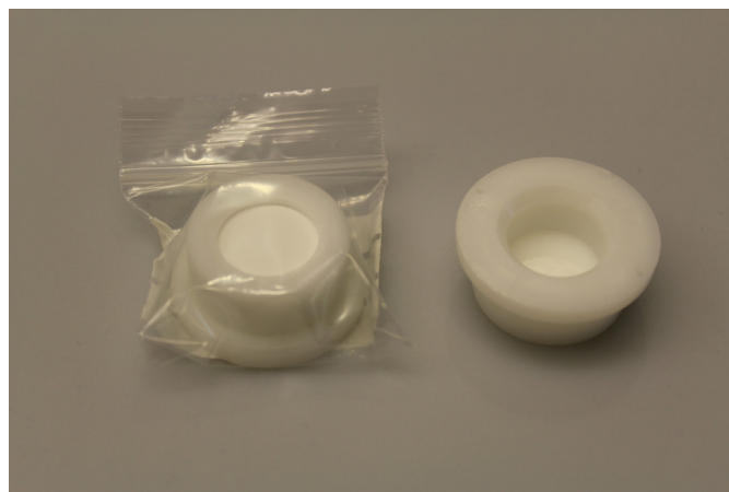
DGT-provtagare för provtagning av metaller, anjoner och PFAS.
