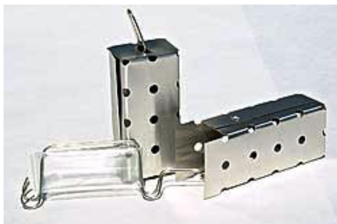
SPMD engångsprovtagare. Redo att sätta ut i vattnet.
