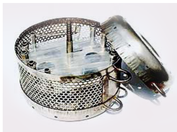
SPMD provtagare. Membranet är monterat på en spindel och är placerad i en provtagningsbur.
